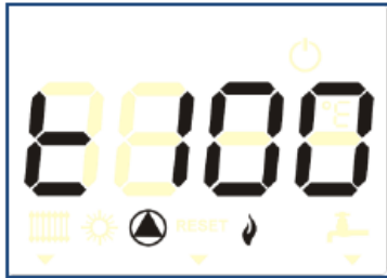
Funcționare în modul service (chimney sweep) la putere maximă
