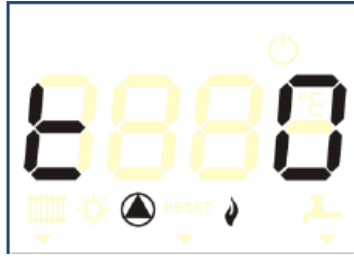
Funcționare în modul service (chimney sweep) la putere minimă
